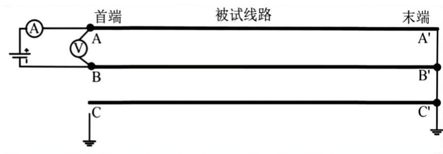
图 3 线路直流电阻测量接线图 (RAB)
