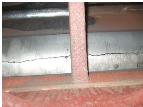
图 1 2008 年 8 月 5 日 1A 氧化风机转子叶轮裂纹
