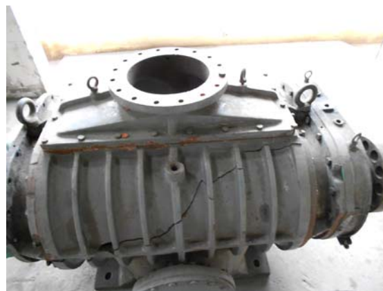
图 3 2014 年 3 月 6 日 1A 氧化风机一级风机损坏
