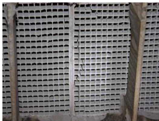
图 4 SK 催化剂进、出断面发生开裂
