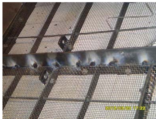
图 3 密封片增加焊点后
