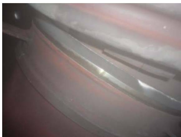
图 6 六抽膨胀部分破裂图
