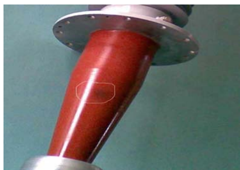
图 11 套管锥体处的放电点
