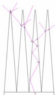
图 4 间于垂直与水平方向入射角度的光线的光路图
