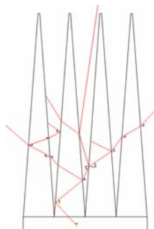
图 3 光线接近水平方向入射的光路图
