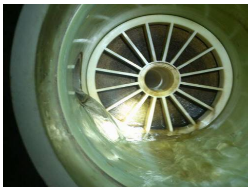
图6 反渗透膜一段进口微生物污染情况
