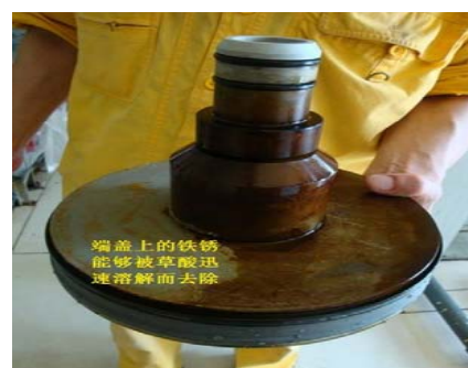
图 2 超滤端盖污堵情况
