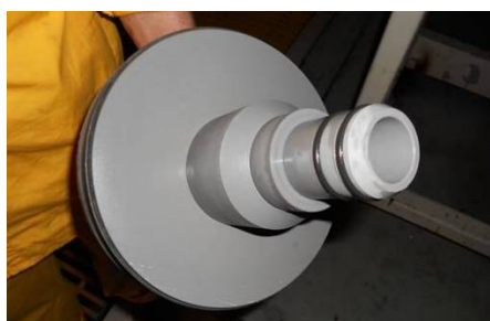
图5 超滤端口清洗后情况
