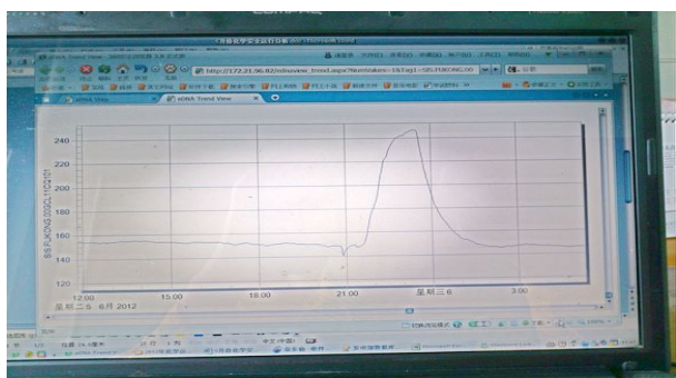
图 9 加药时超滤水箱进口 ORP 上升趋势
