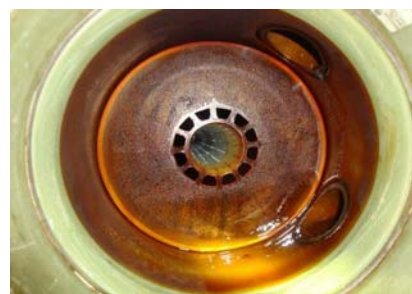
图 1 超滤膜端口污堵情况
