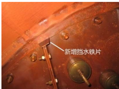
图10 布水多孔板接头处增加挡水装置后示意图
