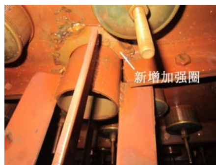
图8 进脂管孔洞新增加强圈示意图
