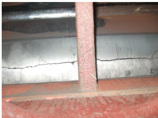
图 1 2008 年 8 月 5 日 1A 氧化风机转子叶轮裂纹
