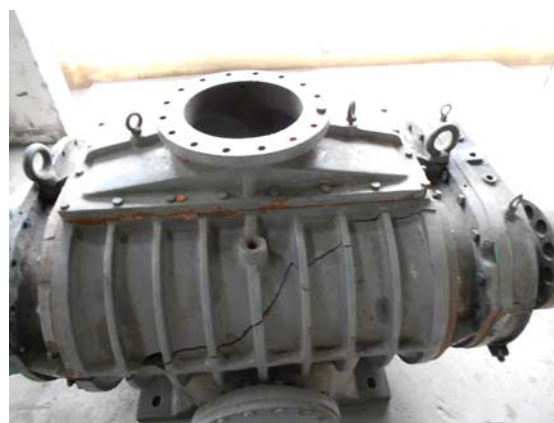
图 3 2014 年 3 月 6 日 1A 氧化风机一级风机损坏
