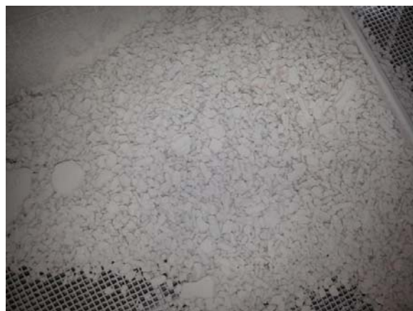
图 5 铁丝网上部清扫的焦粒
