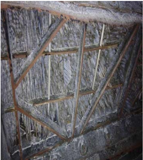
图 1 冷端传热元件盒损坏图
