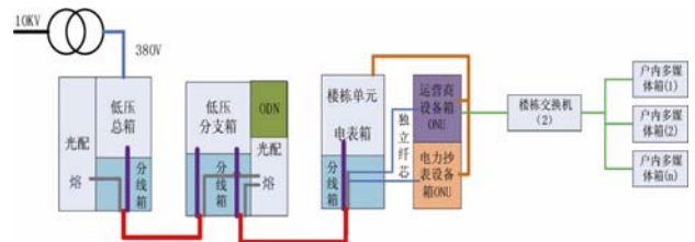
图4 多层房屋电力光纤入户结构图
