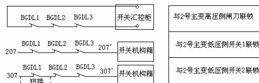
图 2 2 号主变端子箱接线箱短接示意图
