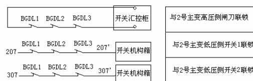
图 1 2 号主变两侧接地电磁锁闭锁回路图
