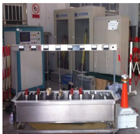
图5 绝缘靴和绝缘手套试验台
