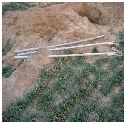
图 3 被锯断的拉线材料
