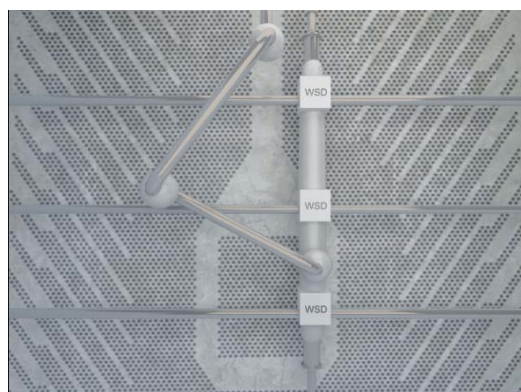
图 4 WSD 冲洗机器人正面示意图
