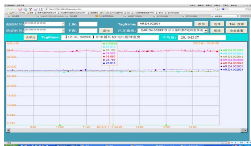
图 3 #4 机闭冷水母管压力为 0.53MPa 时炉水泵电机腔体温度
