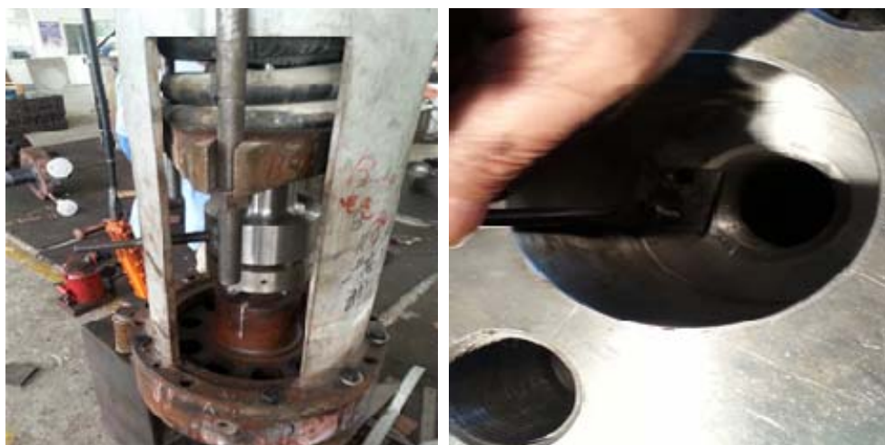
图 5 改进后的法兰连接
