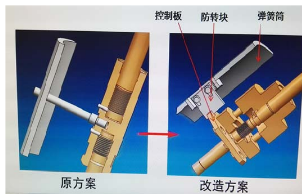
图5 原联结方式与新型联结方式的防止转
