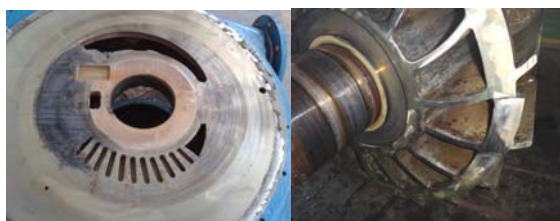
图 1 真空损坏分配器和叶轮
