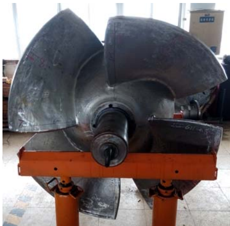
图 6 循环泵叶轮
