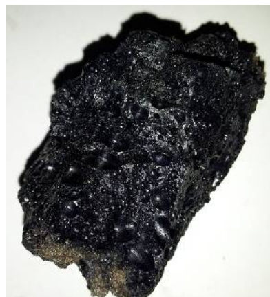
图 6 捞渣机掉落焦块取样 1
