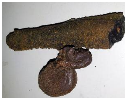
图 4 EF 层#1 角结焦取样
