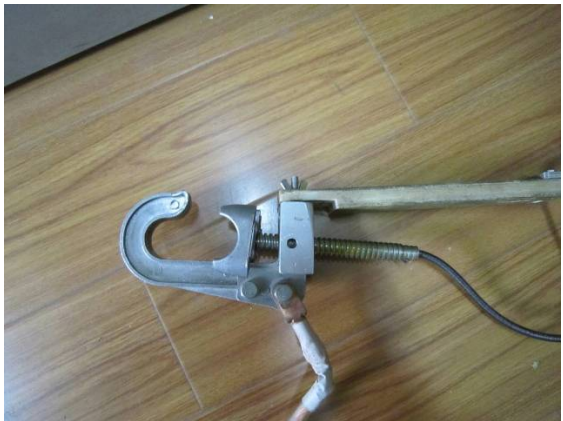
图 7 导线闭紧装置
