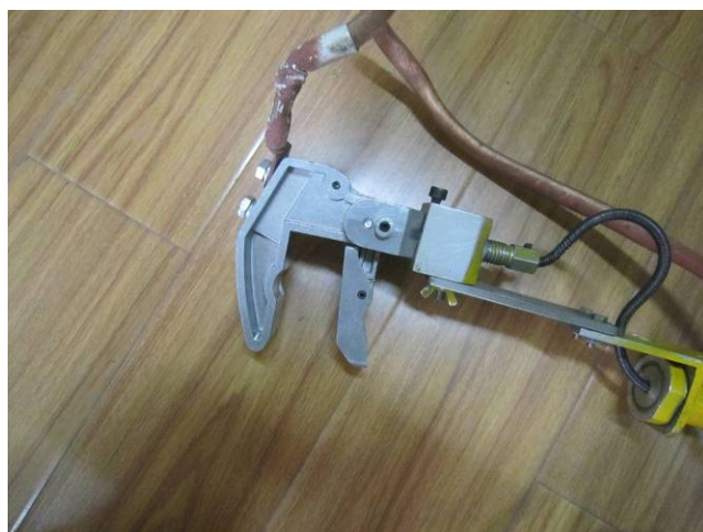
图 11 螺栓夹子式接地线
