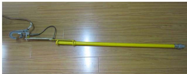
图 10 螺栓钩头式接地线
