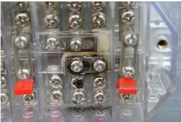
图 4 接线盒底部散落黑色粉末状微粒 有很多原因可能造成这种情况:
