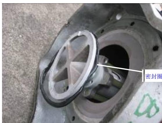
图 3 B 相上节避雷器底部密封圈损坏
