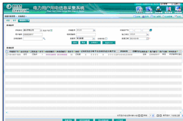
图 9 低压采集通信故障导致零电量
