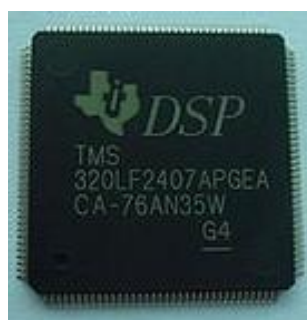
图 6 Ti 公司 TMS320LF2407 芯片
