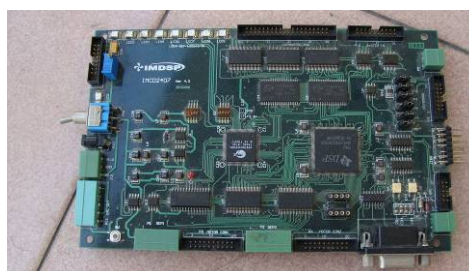
图 7 电机控制电路板
