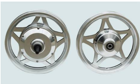
图 10 锂电池用无刷直流电机
