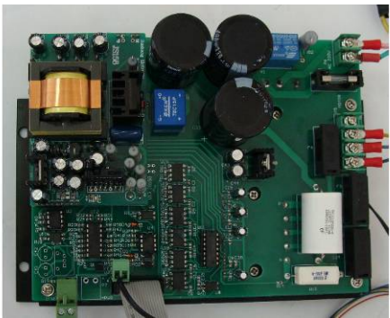
图 12 电动四轮车驱动电路板
