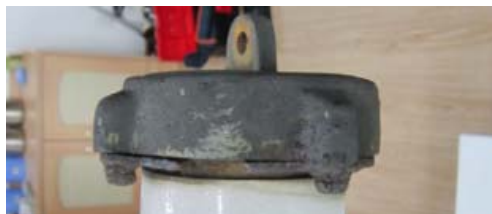
图 3 户外长期运行熔断器两端锈蚀压盖
