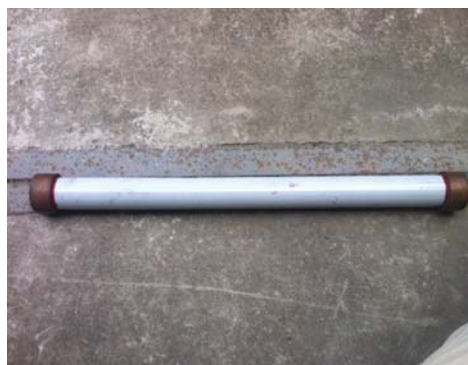
图4 晓庄 356 压变开关柜内损坏的熔丝
