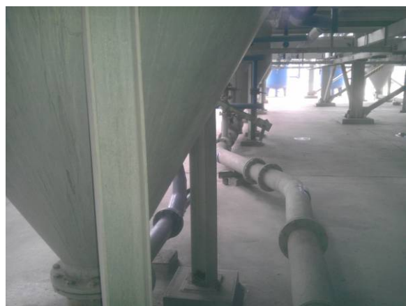
图 2 传统简单的飞灰取样装置 (侧面)
