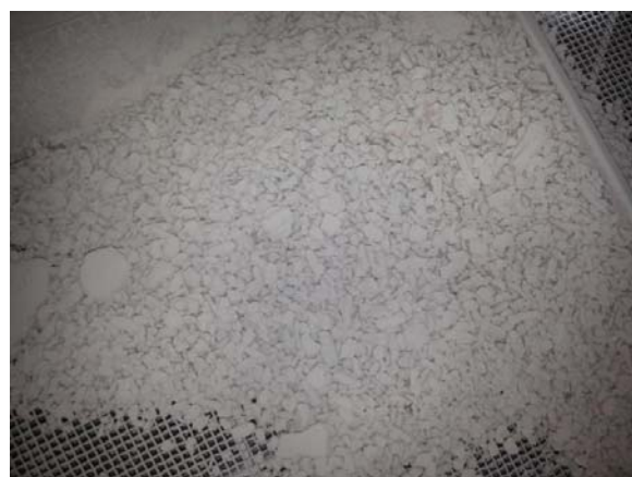
图 5 铁丝网上部清扫的焦粒
