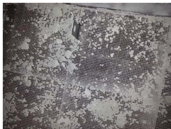
图 4 铁丝网上面的焦粒
