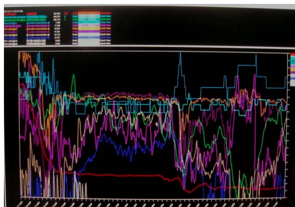
图 3 炉底水封失去后处理过程中汽水参数
